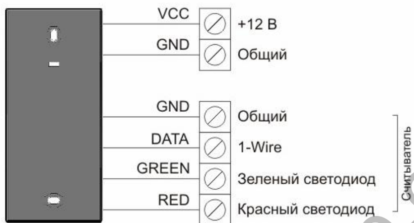
Рис. 1. Подключение по интерфейсу 1-Wire
