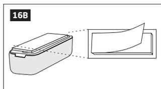
8. Выньте пластиковую пластину находящуюся между одним из контактов и слотом для батарей EWD2.
