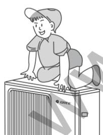
Не загороджуйте повітря-забірний та повітрявипускний отвори зовнішнього та внутрішнього блоків. Це може викликати падіння потужності кондиціонера та привести до порушення його роботи.
