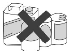
Не загороджуйте повітря-забірний та повітрявипускний отвори зовнішнього та внутрішнього блоків. Це може викликати падіння потужності кондиціонера та привести до порушення його роботи.
