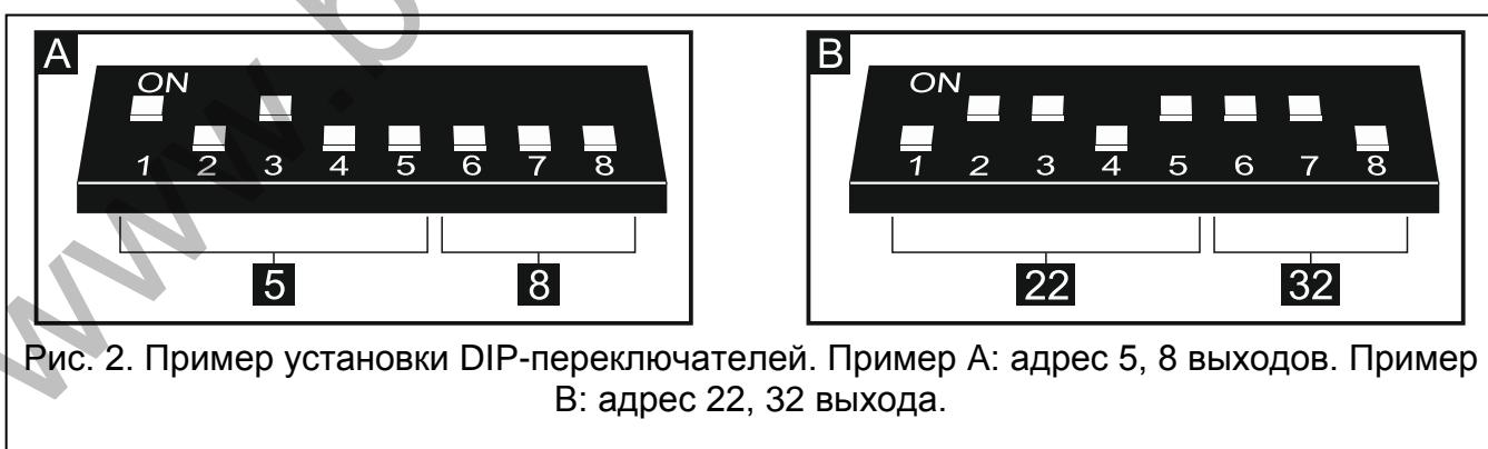
Рис. 2. Пример установки DIP-переключателей. Пример А: адрес 5, 8 выходов. Пример В: адрес 22, 32 выхода.
