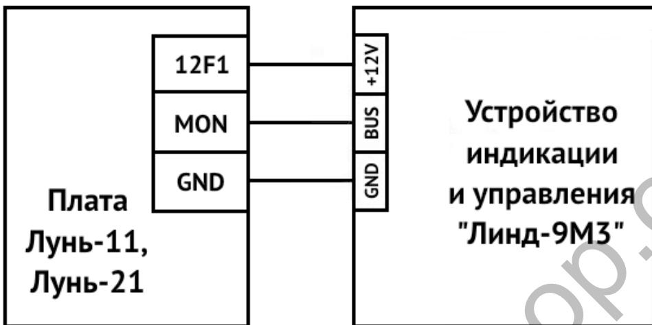
Рисунок 4. Схема подключения УИУ к ППКОП «Лунь-11», «Лунь-21»
