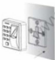
(4) Установите терминал на монтажную пластину.
