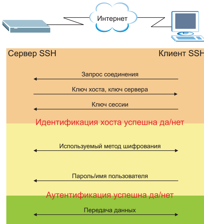
Рисунок 228 Как работает протокол SSH
