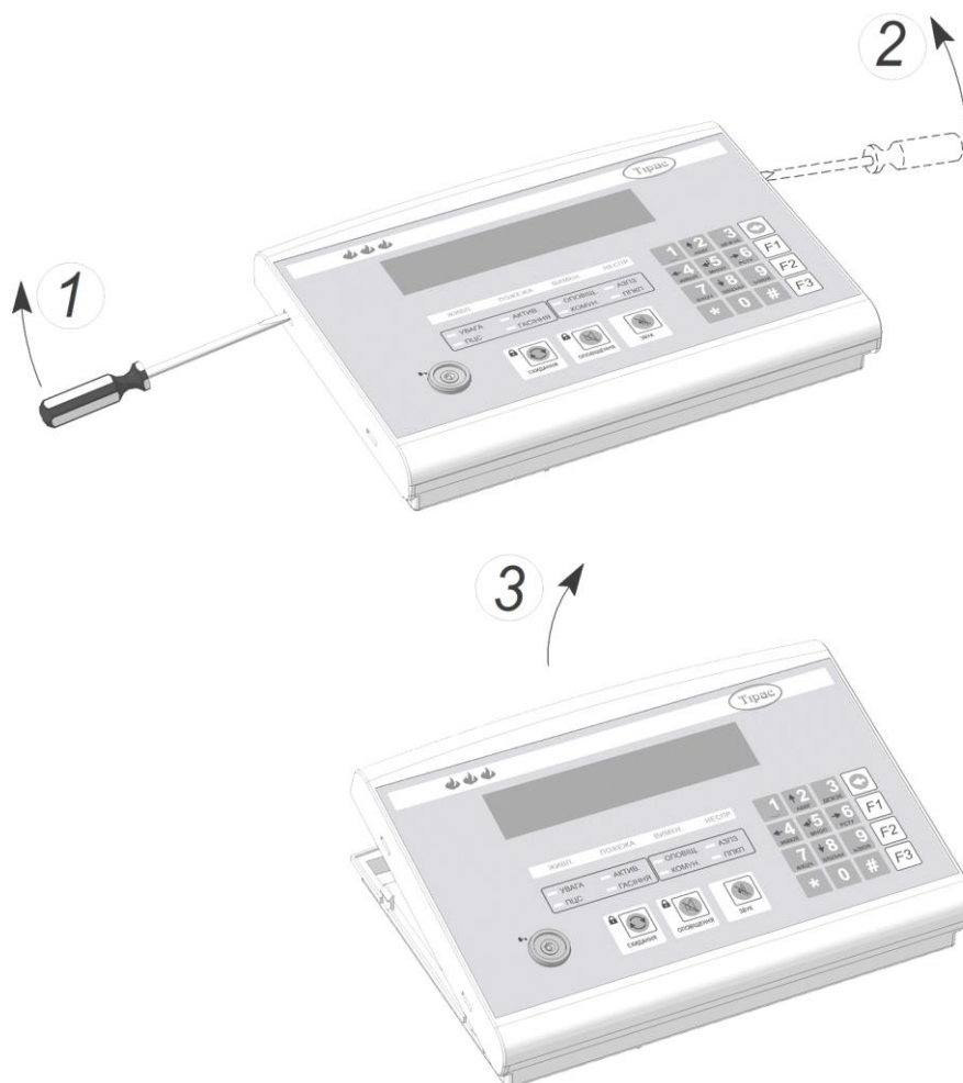
Рисунок 7.7 - Порядок відкривання корпусу приладу
