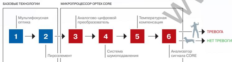
Работа процессора CORE основана на алгоритме логического сравнения формы сигналов от различных источников ИК-излучения. Анализируя полученные данные и сравнивая их с хранящимися в памяти образцами, процессор принимает решение о том, может ли источник этого сигнала быть реальным нарушителем или нет.
