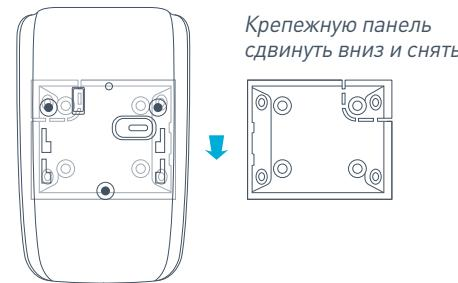
РИС. 1. Датчик CombiProtect и его крепежная панель
