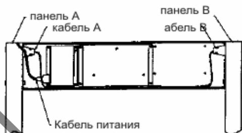
4. Откройте заднюю крышку модуля управления. Соедините шнур питания, а затем кабели А и В с разъёмами на боковых панелях, как показано на рисунке.
