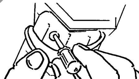
**Регулировка громкости звука:** Включите SUPER SCANNER. Отверните крышку фиксатора. Вставьте маленькую отвертку в шлиц регулировочной головки и легко поворачивайте для настройки громкости. Звук должен быть чуть слышен, если детектор включен, но не обнаруживает металл.
