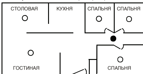
Рис. 5. Расположение детекторов дыма в одном жилом помещении с одной спальней
