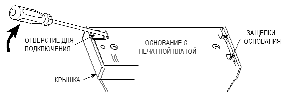
Рисунок 4. Снятие крышки с основания
