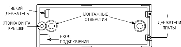
Рисунок 5. Основание со снятой печатной платой
