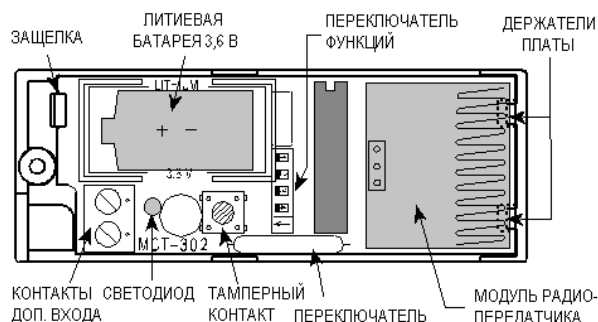
Рисунок 1. МСТ-302/МСТ-302S со снятой крышкой
